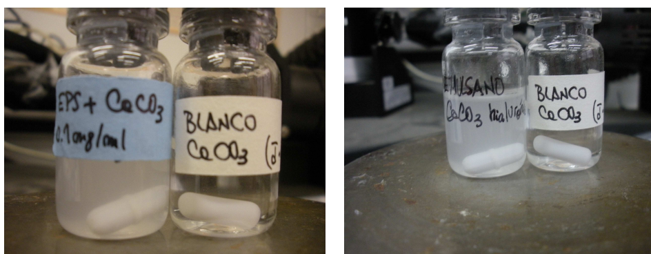
Figura 5. Sistemas de micropartículas híbridas en solución: A. Sistema de recubrimiento con EPS y su control. B. Sistema de Emulsano y su control.
